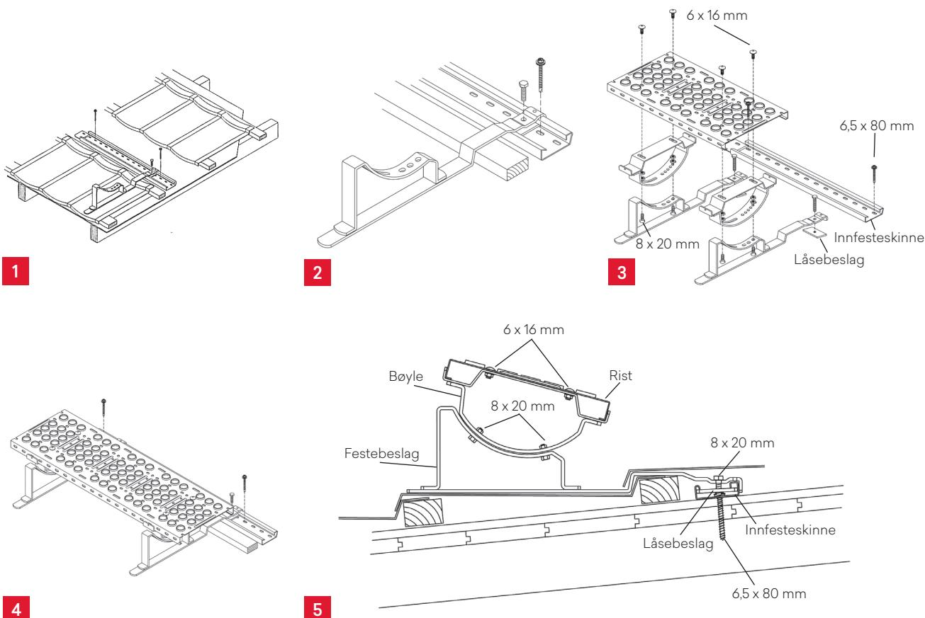
**Det er et krav at festebeslagene festes til en innfesteskinne. Den frie enden på en rist må ikke stikke lengre ut enn 25 cm (avstand fra festebeslag til ristens ende). Det må brukes skruedrill ved montering. Se førøvrig leggeanvisning for takpannen.**
