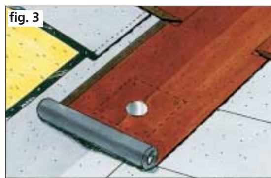
Lavbrekk ved takflater med over 5° fall. Banen forskyves 30/70 i forhold til midten for å unngå dobbelt skjøt med overlaget
