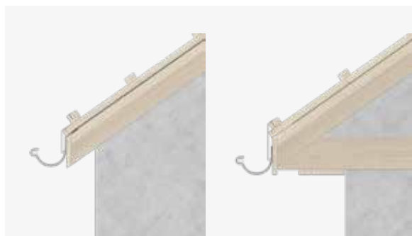
4.1.1.2 Sløyfe ved takfot damp tett undertak
